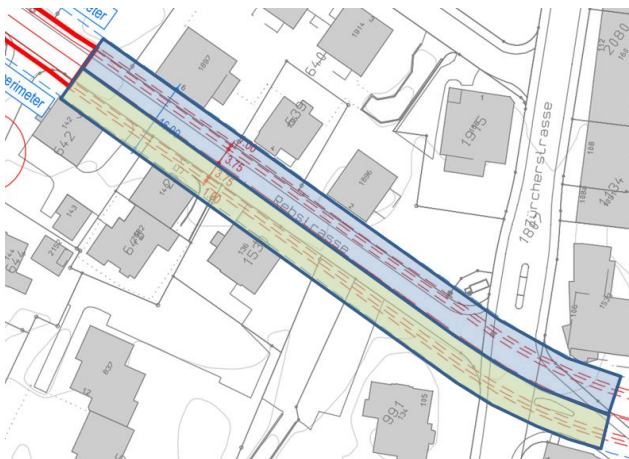
Abbildung 43 Deckelbauweise in zwei Längsetappen in der Rebstrasse
